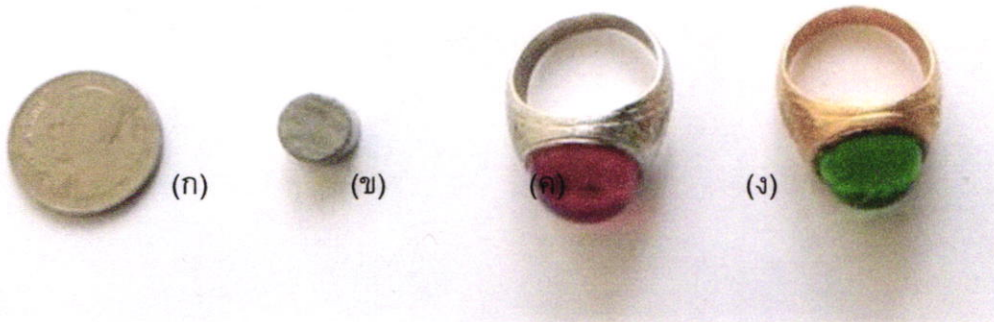
ภาพที่ 1 ตัวอย่างอัลลอยโลหะผสมที่ใช้ในงานวิจัย (ก) เหรียญกษาปณ์ (ข) อมัลกัม (ค) แหวนเงิน และ (ง) แหวนทองเหลือง
